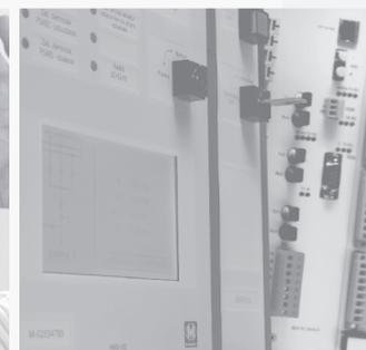
Das SO-5 System stellt eine offene Konstruktion dar. Zu seinen Vorteilen gehört eine einfache Erweiterung der Kommunikation zu Schutzeinrichtungen, Störschreibern und Schaltgeräten verschiedener Hersteller. Das System ermöglicht den Versand von SMS-Benachrichtigungen und eine Fernbedienung über Webseiten.
