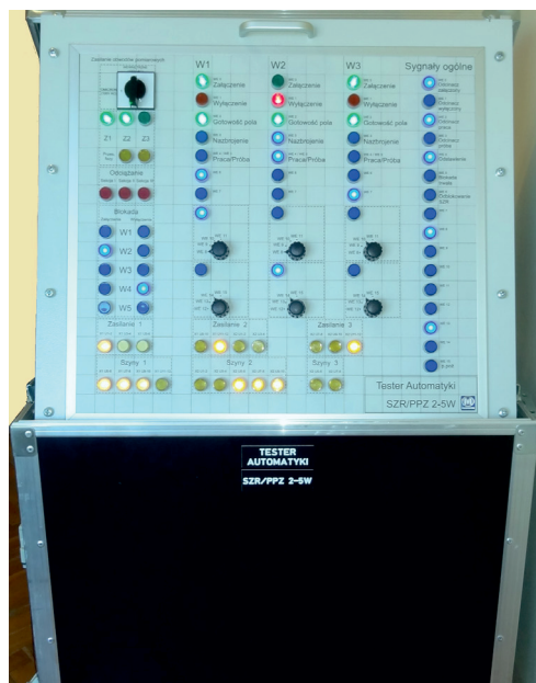
Rys. 7. Tester automatyki SZR/PPZ/SPP 2-5W
